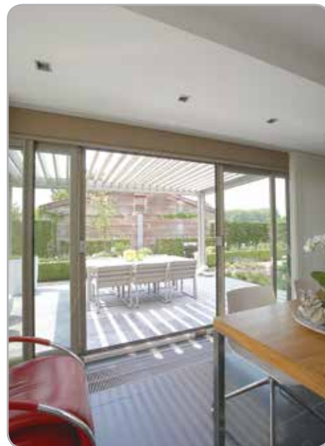
Intégration de protection solaire verticale résistant au vent grâce à la technologie Fixscreen®
